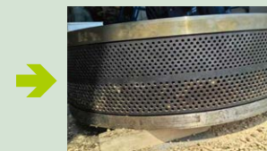
ペレット製造機内部
