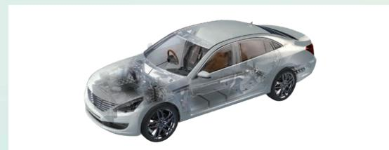
カーボンニュートラル実現を目指し各自動車メーカーがCO<sub>2</sub>削減に取り組む中、JFEグループが自動車用鋼材として開発、販売しているハイテン材は、板厚を薄くしても、車体の強度を維持・向上させられることから、自動車の軽量化に繋がる鋼材として、採用比率が高まっています。2021年には、メキシコで新たな自動車用鋼板の加工・販売拠点が稼働し、お客様のニーズに応える体制を整えています。
